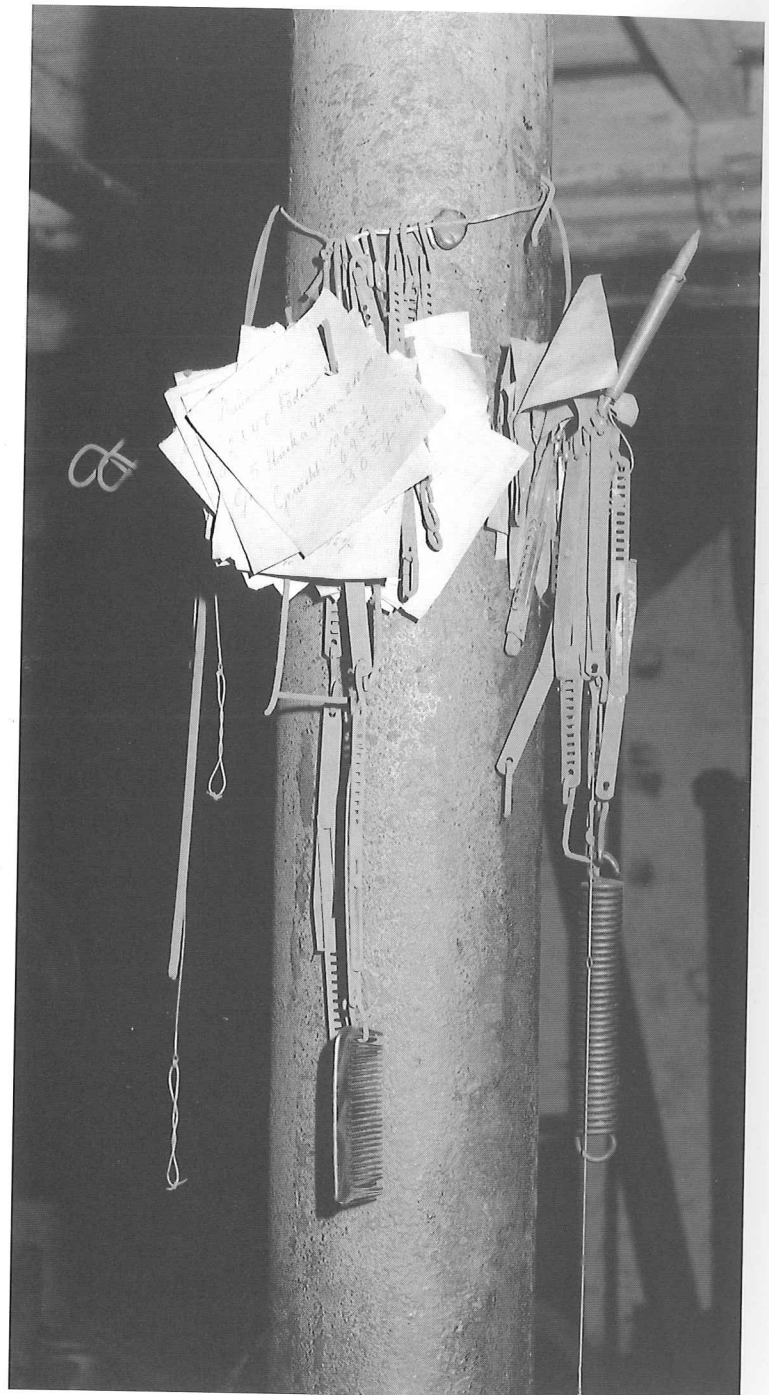
Abb. 29: Griffbereit hängen an einer Säule in der Weberei verschiedene Hilfsmittel für den Arbeitsalltag: ein Kamm zum Entwirren der Kette, Stückzettel und Ersatzteile.
